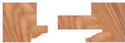
DETALLE DE LA SECCIÓN DE UNA PUERTA CRISTALERA CON GALCE. REBAJE HABITUAL DE 11m.m.
